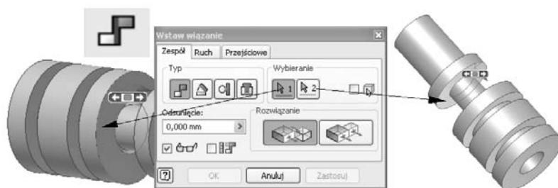
Rysunek 4.23. Definiowanie zespołu za pomocą wiązań współliniowości
